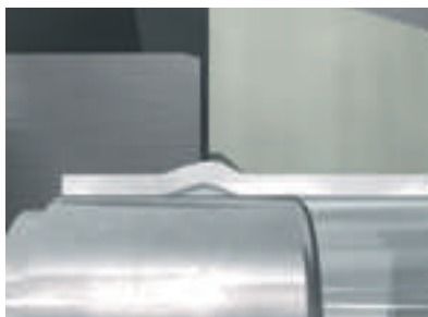
Форма инструмента определяет внешний контур деформированной стенки трубы
